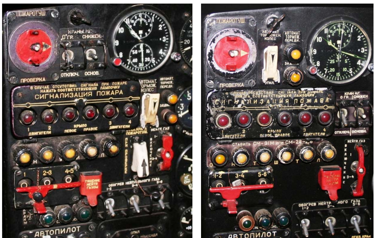
Рис. 15. Щитки управления и сигнализации системы пожаротушения, установленные на другие самолеты типа Ан-12
