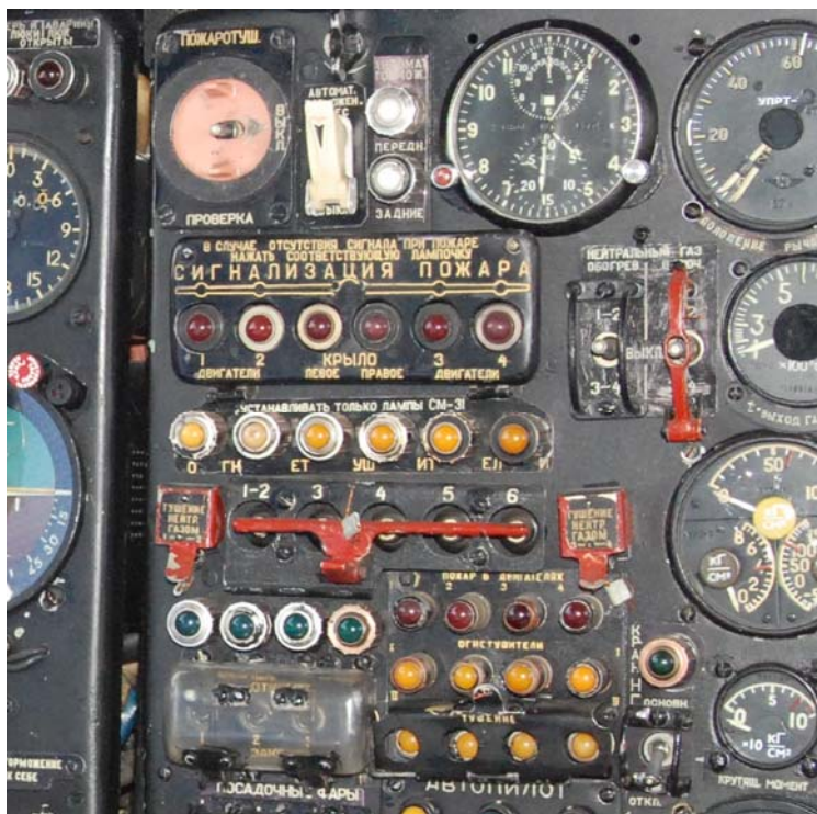
Рис. 13. Щиток управления и сигнализации системы пожаротушения, который был установлен на самолете Ан-12 АП RA-11125
