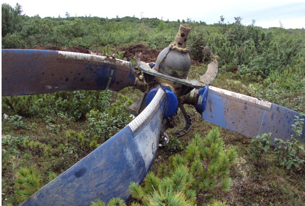
Рис. 26. Воздушный винт СУ № 1 на месте АП. Лопастей ВВ во флюгерном положении
