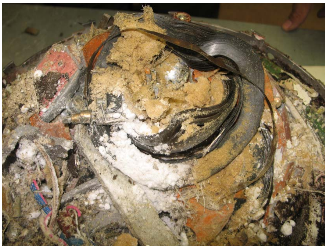
Рис.4. Внешний вид штатного контейнера после вскрытия (верхняя катушка с магнитной лентой)
