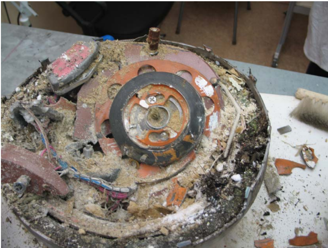
Рис.5. Внешний вид штатного контейнера после вскрытия (нижняя катушка с магнитной лентой)
