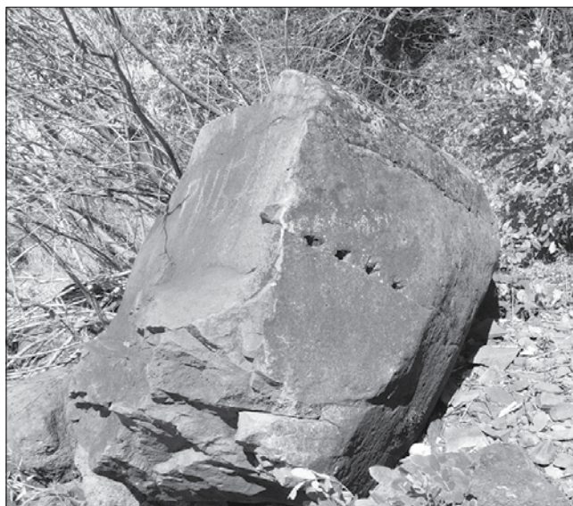
Подготовка камня к разделке на блоки
