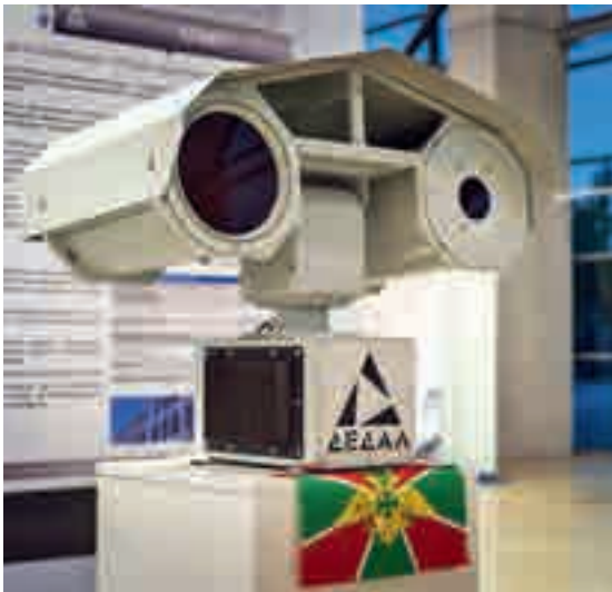
ДВУХСПЕКТРАЛЬНОЕ УСТРОЙСТВО КОНТРОЛЯ ПЕРИМЕТРА «КИВЕР» СПОСОБНО ОБНАРУЖИТЬ НАРУШИТЕЛЯ В ЛЮБЫХ ПОГОДНЫХ УСЛОВИЯХ
