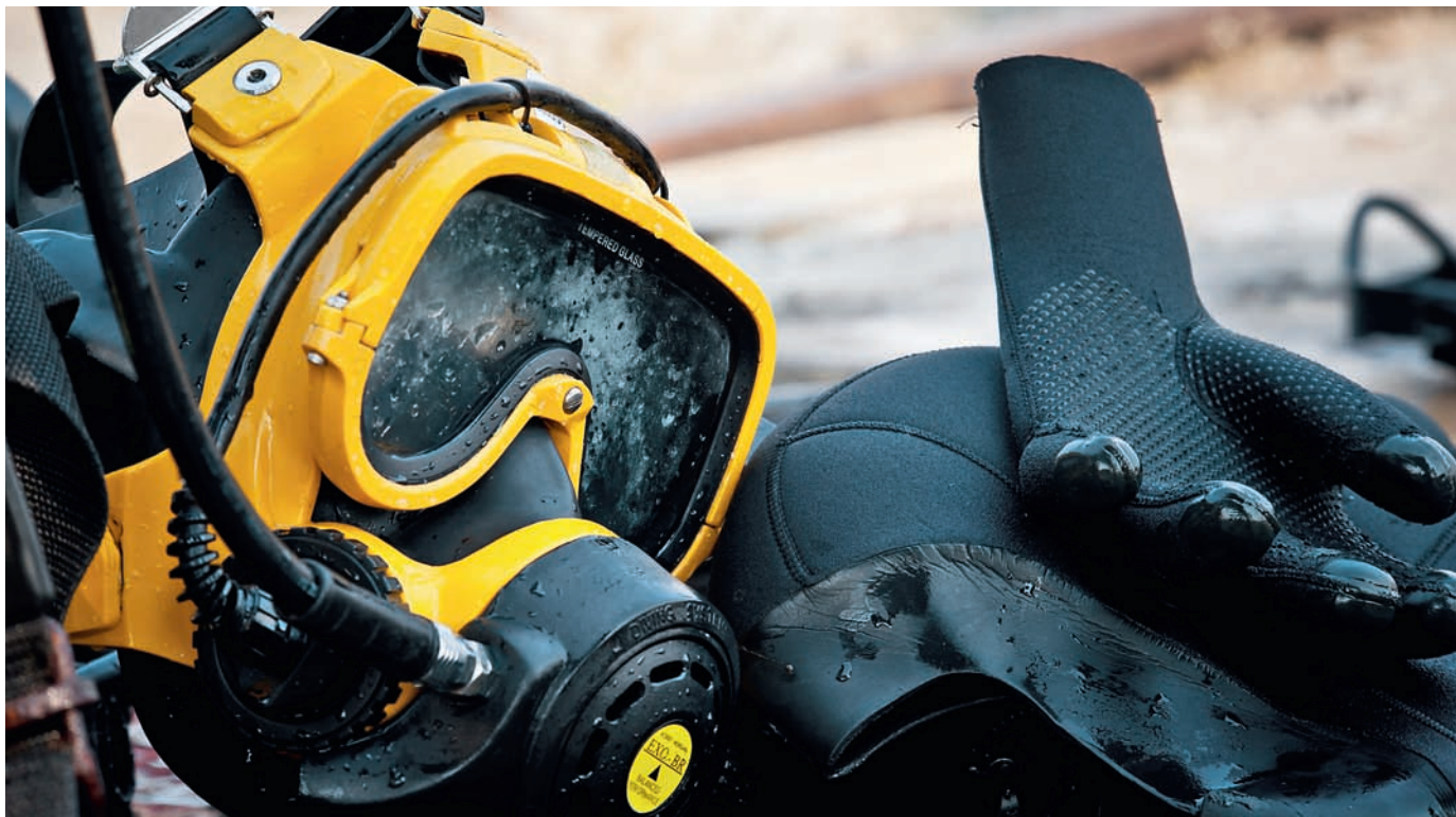
В ТАКУЮ МАСКУ ВСТРОЕНО ПЕРЕГОВОРНОЕ УСТРОЙСТВО, БЛАГОДАРЯ КОТОРОМУ ВОДОЛАЗ МОЖЕТ ОБЩАТЬСЯ С ТЕМИ, КТО НАХОДИТСЯ НА ПОВЕРХНОСТИ
