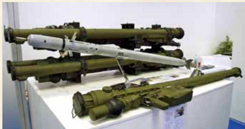
ПЕРЕНОСНОЙ ЗЕНИТНО-РАКЕТНЫЙ КОМПЛЕКС «СТРЕЛА» ПРЕДНАЗНАЧЕН ДЛЯ ПОРАЖЕНИЯ ВОЗДУШНЫХ ЦЕЛЕЙ НА СРЕДНИХ, МАЛЫХ ВЫСОТАХ, А ТАКЖЕ НИЗКОЛЕТАЮЩИХ ОБЪЕКТОВ
