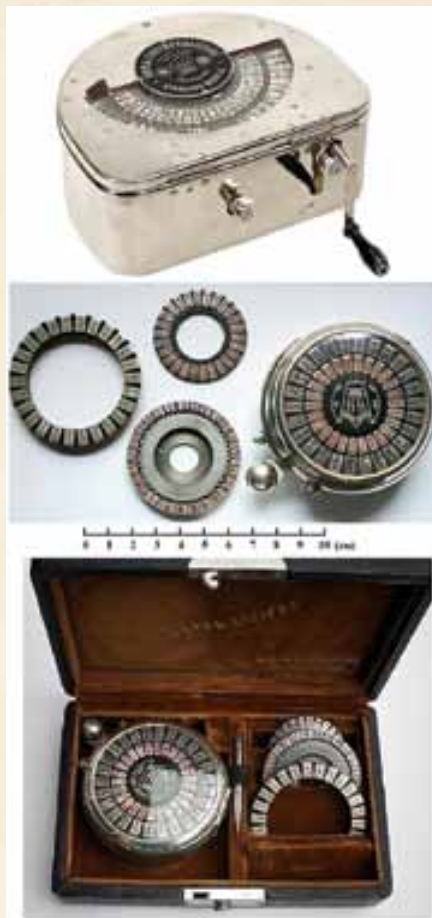
ШИФРАТОР КРЮНА И ЕГО КАРМАННАЯ ВЕРСИЯ КРЮНА ЛИЛИПУТ
