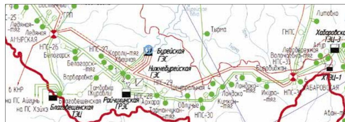
Рисунок 3.79. Схема выдачи мощности Бурейской ГЭС.
