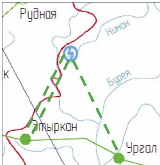
Рисунок 3.68. Схема выдачи мощности Верхнениманской ГЭС.
